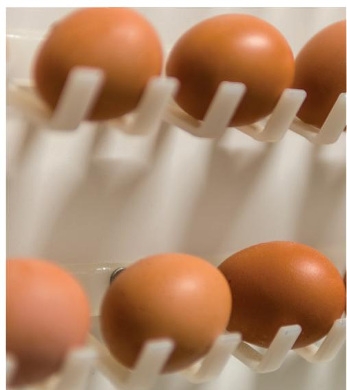
集蛋系統的運轉速度可根據雞蛋數量調整，便於現場人員作業。FACCO研發出全球第一套NIGARA集蛋系統，至今已有數十年歷史，具有可調式集蛋速度、高耐用性、高可靠性、耗損率低等優點，且只需簡單的定時維護即可穩定運轉。而此系統最重要的特色是能大幅減少「蛋殼的隱藏性裂痕」，因為每一個處理流程都經過精心計算跟專業設計，這也是得NIAGARA集蛋系統成為最受其他廠商模仿的設計之一。
